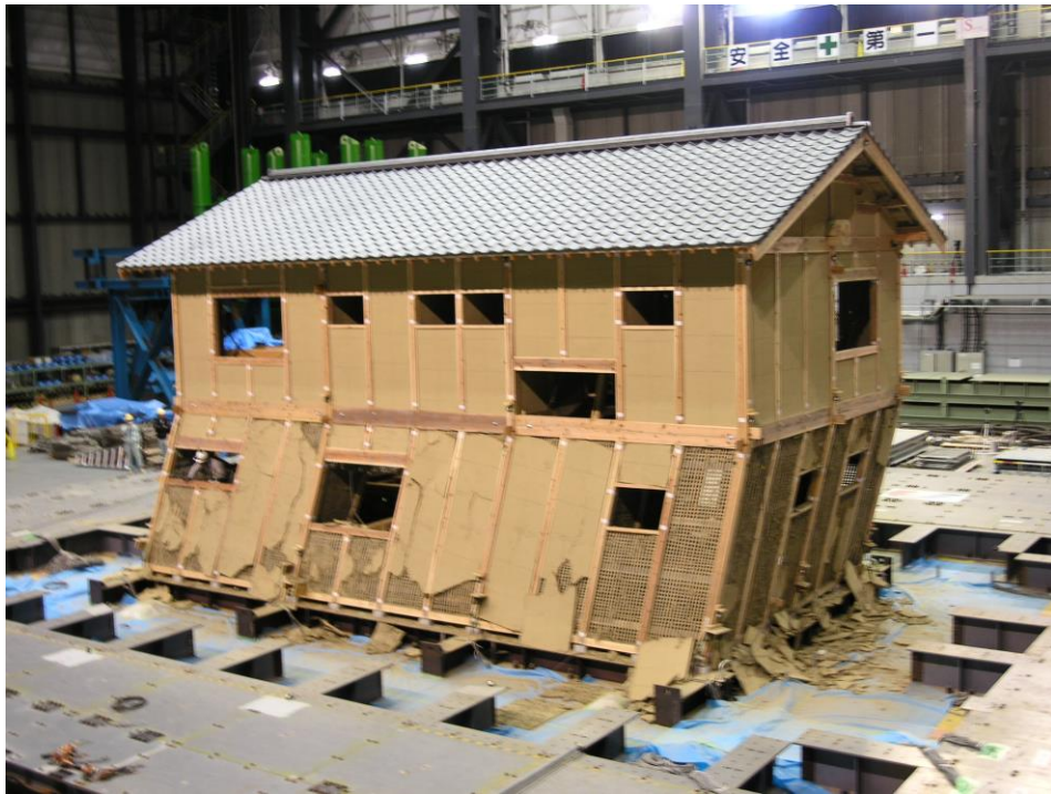
実験によって通し柱が折れて傾いた土壁の「伝統構法の建物」
